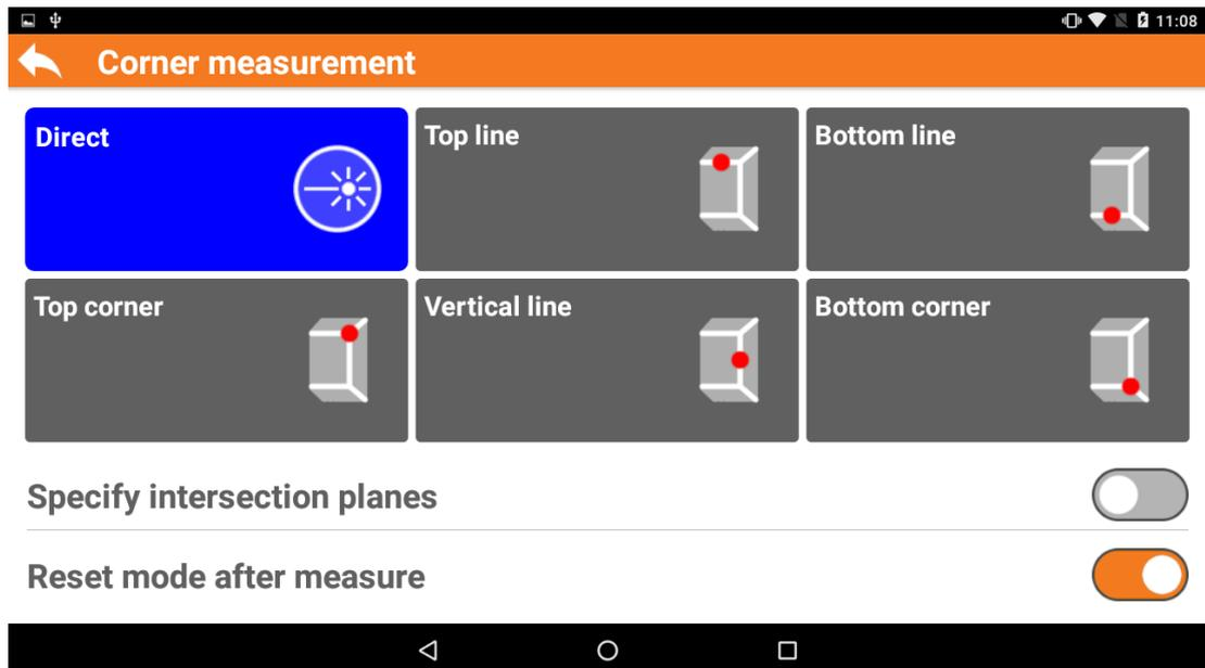
Diese Option stellt eine Alternative zu der Standardmessung dar. Um die automatische Identifikation von Kanten zu starten, drücken Sie die Schaltfläche
