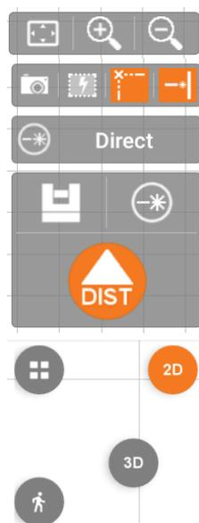
Fotoaufnahme, Rechteckerkennung, Automatische Eckenerkennung und Aktiver Laserpointer.
