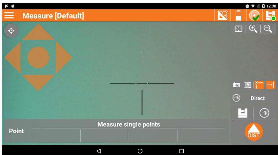
Die Schaltfläche in der Mitte der Pfeile erlaubt die Verschiebung der Zoom3D mit dem Akzelerometer Sensor des Tablets (wenn vorhanden).
