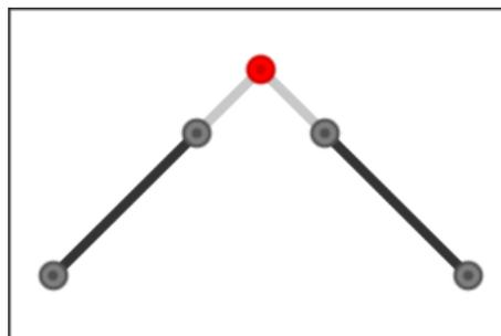
**X-PAD MasterPlan** erkennt automatisch diese Situation und fordert Sie auf, den berechneten Punkt zu speichern, basierend auf dem Schnittpunkt von den zwei Linien, die auf den zwei gegenüberliegenden Mauern gemessen wurden.
