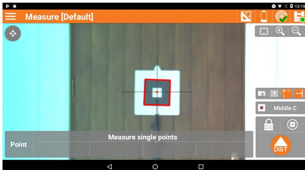
Um ein Ziel zu erkennen, muss die Zoom3D ein ausreichendes Sichtfeld haben. Deswegen ist es notwendig, die Zoomstufe der Kamera in Abhängigkeit von der Entfernung zwischen dem Ziel und der Zoom3D anzupassen. Um dies zu unterstützen ist eine Option verfügbar, die die Zoomstufe automatisch anpasst.
