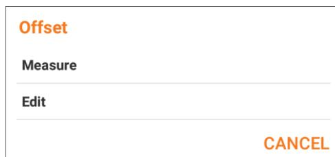
**Messen:** Messen Sie die Offset-Entfernung oder den Punkt, der verwendet wird, um die Offset-Entfernung zu berechnen. Die Offset-Entfernung ist die gleiche wie die Entfernung zwischen der Referenzlinie und dem zuvor gemessenen Punkt.
