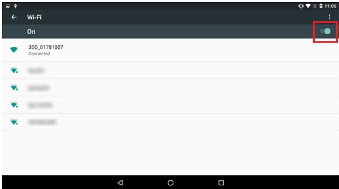
Die WLAN-Verbindung ist für die Arbeit bis zu einer Entfernung von 50 Meter von der Zoom3D eingestellt. Es wird empfohlen, dass der Anwender sich möglichst nicht zwischen der Zoom3D und dem Tablet befindet, wenn über weite Entfernungen gearbeitet wird.
