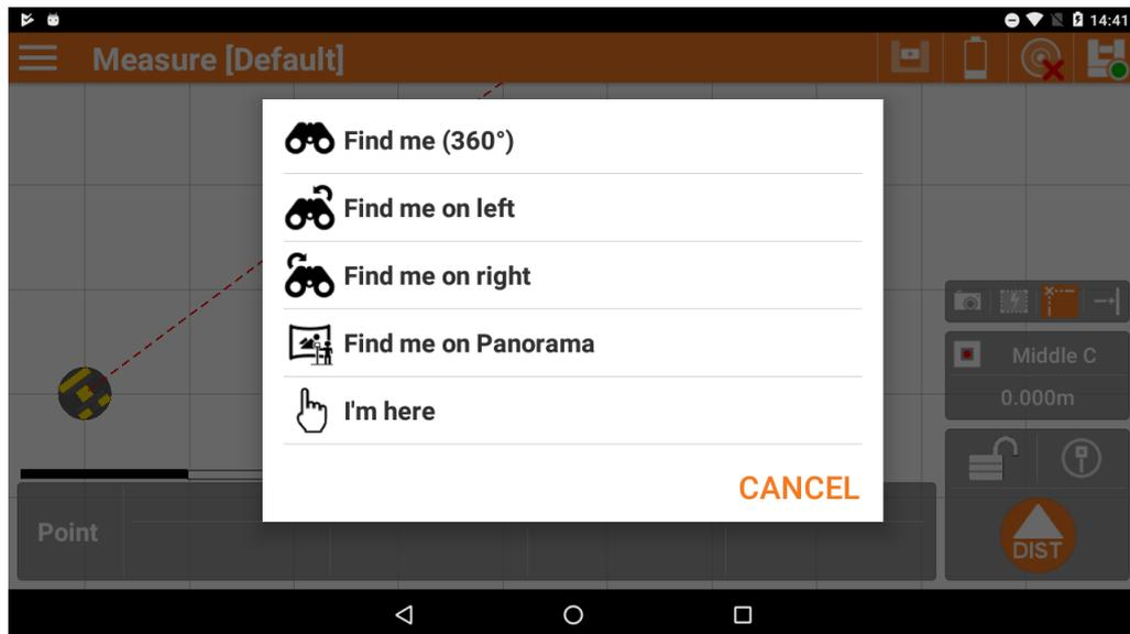
Im kontextsensitiven Menü können Sie eine Zielsuche in einigen der zuvor beschriebenen Modi starten und die Funktion **Ich bin hier** ist auch verfügbar. Mit dieser Funktion können Sie direkt mit der grafischen Ansicht interagieren. Die **Zoom3D** dreht sich entsprechend der angezeigten Position.
