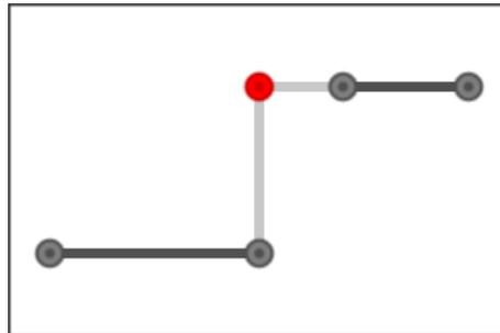
In dieser Situation ist es notwendig, zwei Punkte an der ersten Wand zu messen, und dann zwei weitere Punkte an der nächsten Wand. **X-PAD MasterPlan** erkennt wieder automatisch die Situation und fragt Sie, ob Sie den berechneten, nicht messbaren Punkt speichern wollen.
