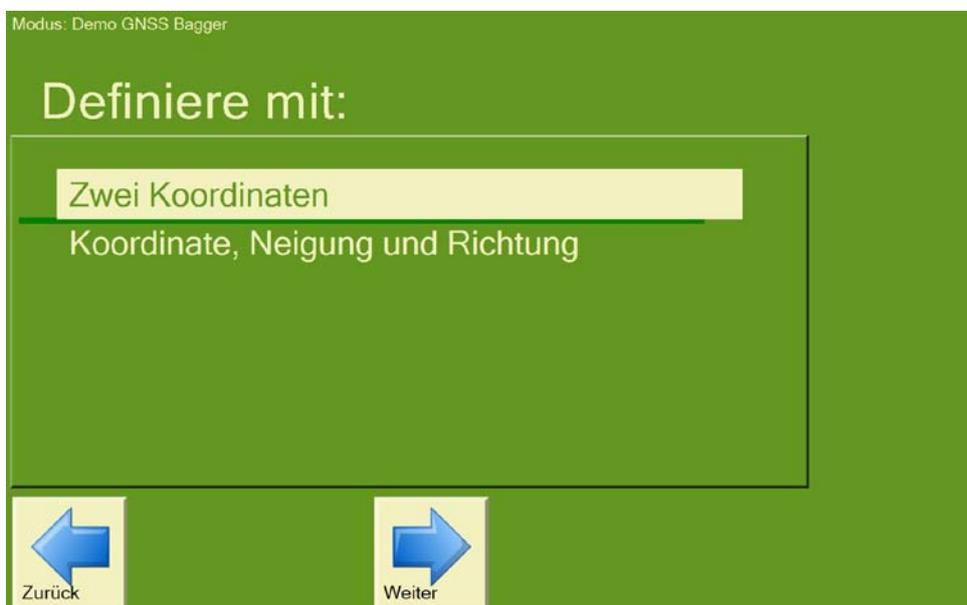
Legen Sie die erste Koordinate fest, indem Sie sie entweder eingeben (Typ) oder den Löffel am Referenzpunkt platzieren (z. B. Vermessungspunkt).
