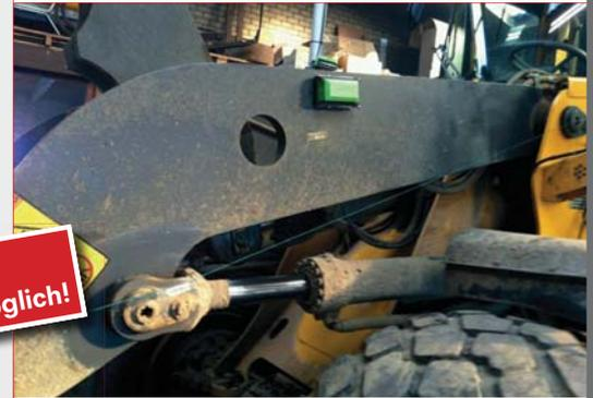
Installierter Sensor am Radlader
