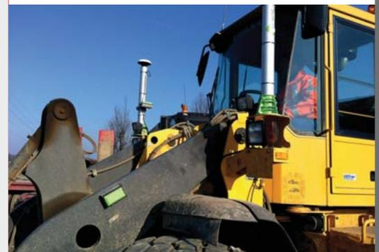
Zwei GNSS-Antennen auf dem Radlader
