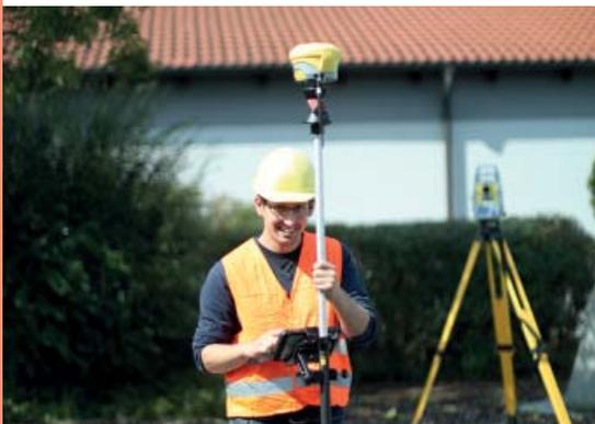
X-Pole: Messung auf Prisma und mit Empfänger
