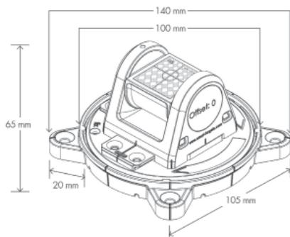
**Reflexzielmarke 20x20 oder 30x30 mm im drehbaren Kunststoffgehäuse**
