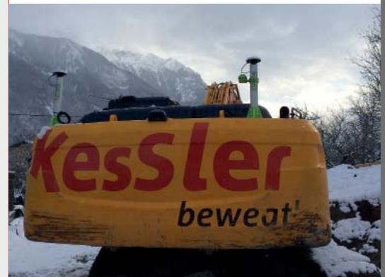
Einrichten eines Baggers mit GNSS-Empfängern
