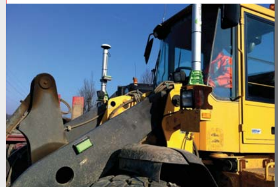
Zwei GNSS-Antennen auf dem Radlader
