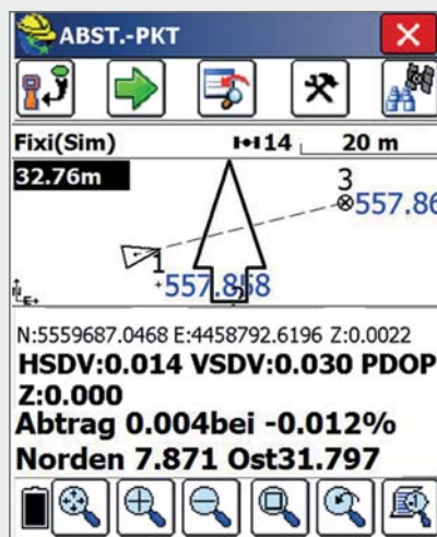
Abstecken mit Richtungspfeil
