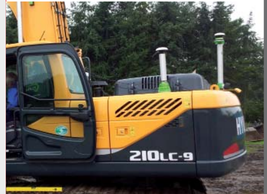
Zwei DigPilot-Antennen verbunden mit der GNSS-Box im Bagger liefern dem System Position, Höhe und Peilung des Baggers
