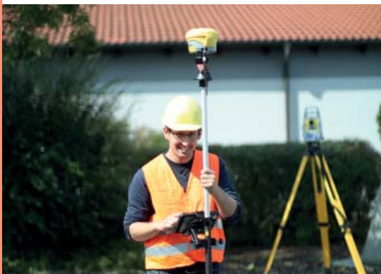
X-Pole: Messung auf Prisma und mit Empfänger
