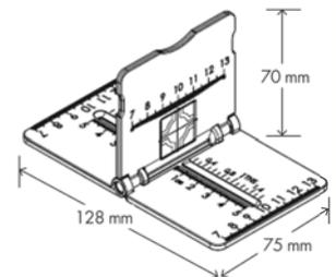
**Absteckhilfe RS150M mit Mini Prisma für Robotik-Totalstationen**
