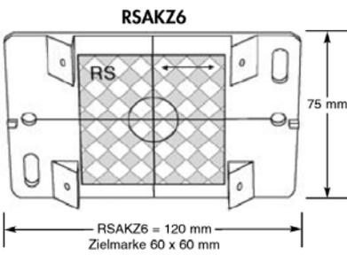
Um die Sicherung des Vermessungspunktes über einen längeren Zeitraum zu gewährleisten wurden auf den Trägerplatten Markierungen angebracht um eventuell beschädigte Reflexzielmarke problemlos austauschen zu können und den Originalvermessungspunkt einfach, schnell und kostengünstig wieder her zu stellen.
