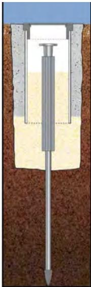
Das Profil sollte bis ca. einen Meter tief unter die Erdoberfläche gesetzt werden, um diesen Schutz zu gewährleisten. Unter dieser Tiefe ist nur mit geringen Bewegungen zu rechnen und der Punkt sitzt stabil. Als Bezugspunkt wird auf die letzte Stabmarke ein Abschlussbolzen mit Zentrierung oder eine Abschlussmarke mit 64 mm Durchmesser gesetzt. Dieser bietet ausreichend Platz für die Kennzeichnung mit individuellen Aufschriften.
