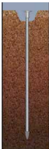
Stabvermarkung mit Profilabschluss
