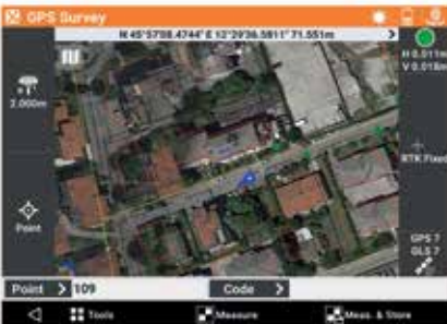
Einblendung eines Luftbildes über den Plan
