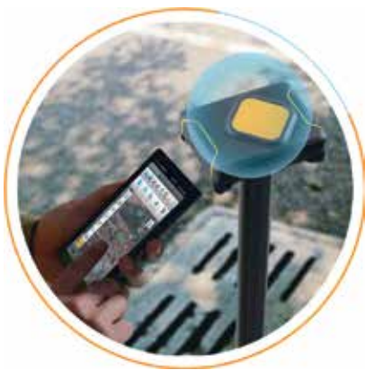
Qbox8 am Arm oder am GNSS-Stab
