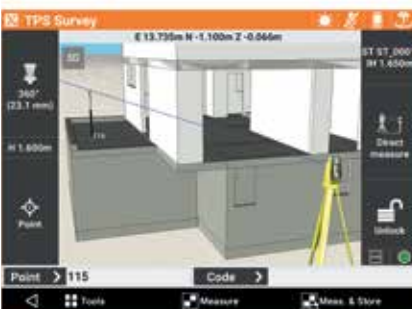
3D-Ansicht zur Aufnahme und Abstecken mit Tachymeter
