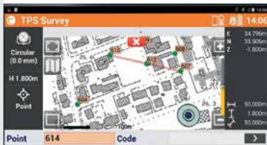
X-PAD Vermessungssoftware direkt auf der Zoom40/50
