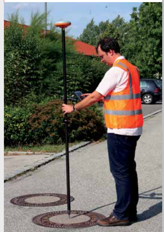
Verwendung des Tablets mit GNSS-Empfänger NR3 und Esri-Engine zur Aufnahme eines Kanaldeckels
