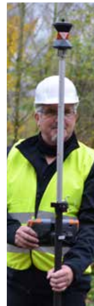
Nutzung des Tablets Mesa3 mit 360°-Prisma am Stab
