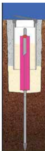
Stabvermarkung mit Schutzprofil
