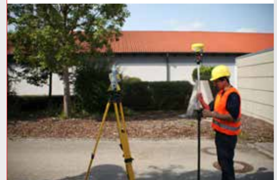
X-Pole: GNSS-Empfänger Zenith35PRO und 360°-Prisma kombiniert Aufnahme und Stationierung in einem Arbeitsschritt!
