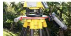
Rechnerhalterung 360 für Zoom70 oder Zoom90 mit Mesa2 Tablet in der Zwei- Mann-Version
