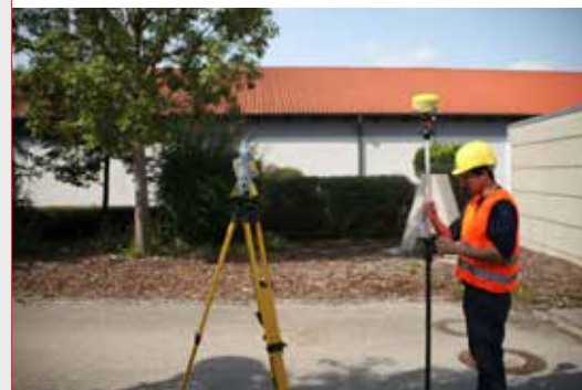
X-Pole: GNSS-Empfänger Zenith35PRO und 360°-Prisma kombiniert Aufnahme und Stationierung in einem Arbeitsschritt!
