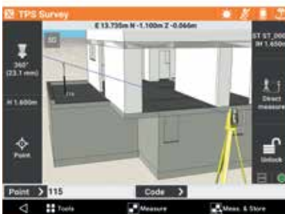
3D-Ansicht zur Aufnahme und Abstecken mit Tachymeter
