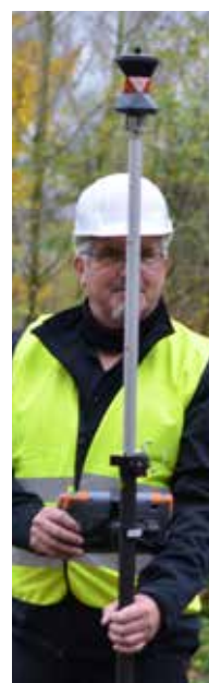
Nutzung des Tablets Mesa2 mit 360°-Prisma am Stab
