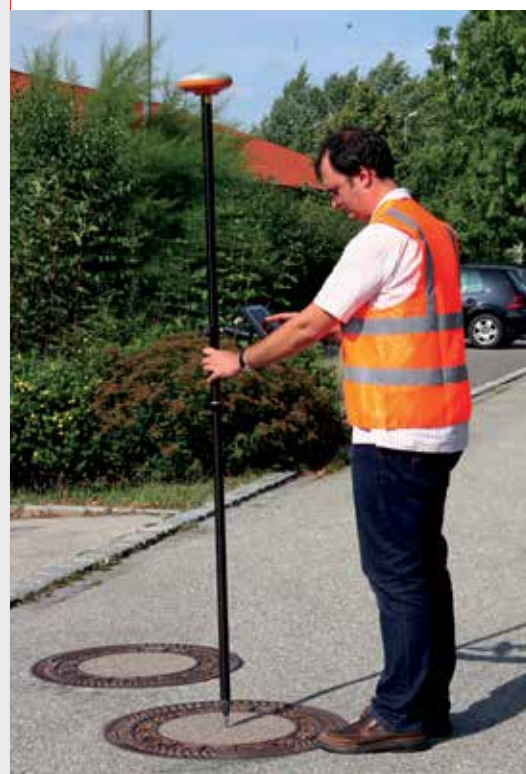
Verwendung des Tablets mit GNSS-Empfänger NR3 und Esri-Engine zur Aufnahme eines Kanaldeckels
