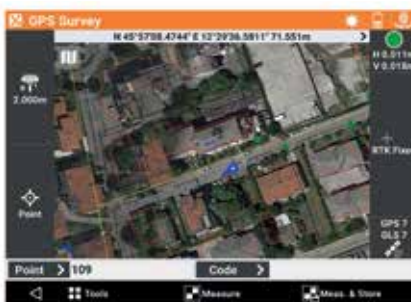
Einblendung eines Luftbildes über den Plan
