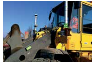
Zwei GNSS-Antennen auf dem Radlader
