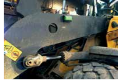
Installierter Sensor am Radlader
