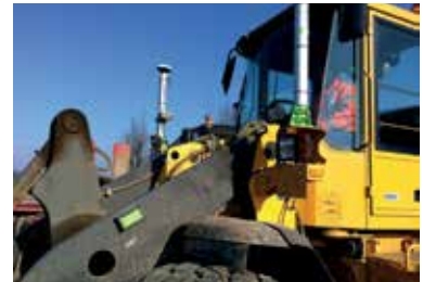
Zwei GNSS-Antennen auf dem Radlader
