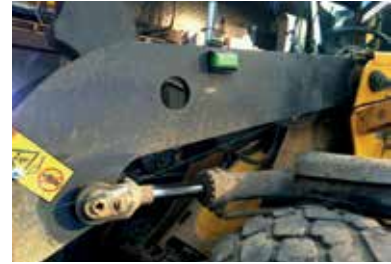
Installierter Sensor am Radlader
