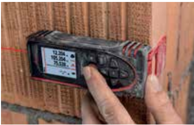
X3 - Messung mit Endstück
