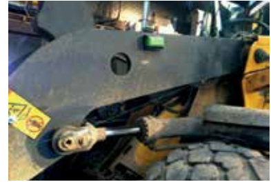
Installierter Sensor am Radlader
