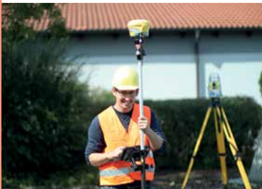
X-Pole: Messung auf Prisma und mit Empfänger
