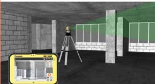
Anzeige des Messpunktes im Kamerabild
