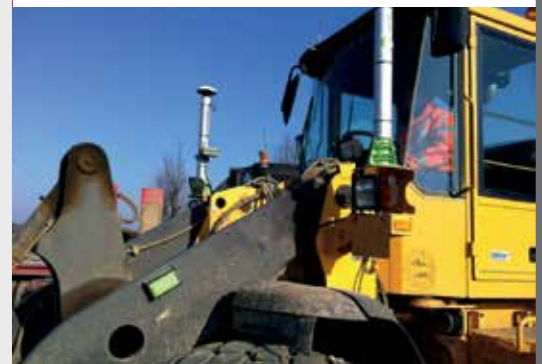
Zwei GNSS-Antennen auf dem Radlader
