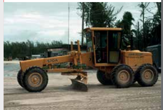
Grader für ebene oder geneigte Flächen
