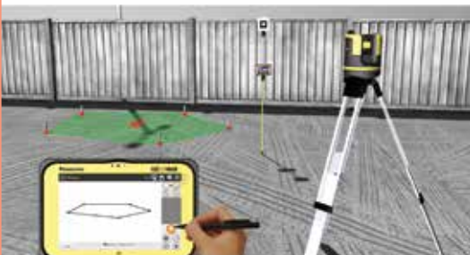
Flächenmessung im Außenbereich
