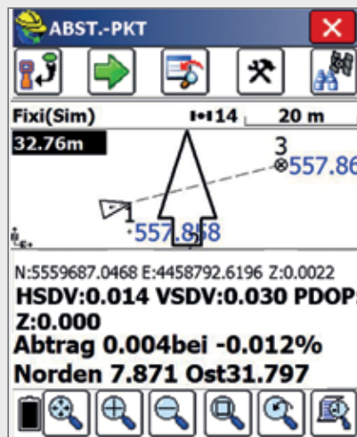
Abstecken mit Richtungspfeil
