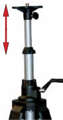
**Schweres Stativ aus Fiberglas mit Schraub- und Schnellklemmung**
