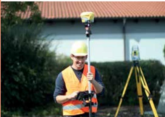
X-Pole: Messung auf Prisma und mit Empfänger
