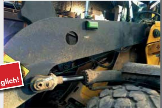
Installierter Sensor am Radlader
