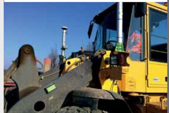
Zwei GNSS-Antennen auf dem Radlader
