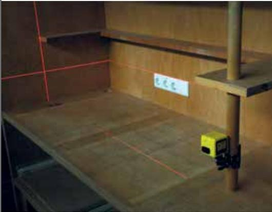
**PNLL360 Linienlaser mit 360°-Horizontallinie und zwei Vertikalen**
