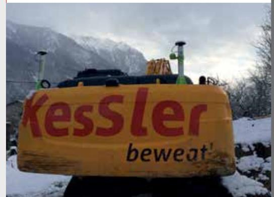
Einrichten eines Baggers mit GNSS-Empfängern
