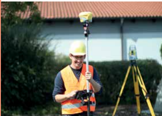
X-Pole: Messung auf Prisma und mit Empfänger
