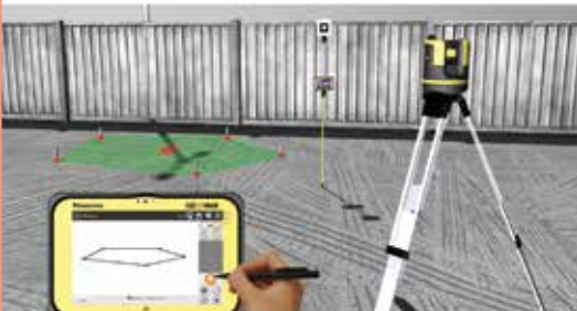
Flächenmessung im Außenbereich
