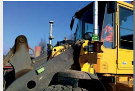
Zwei GNSS-Antennen auf dem Radlader
