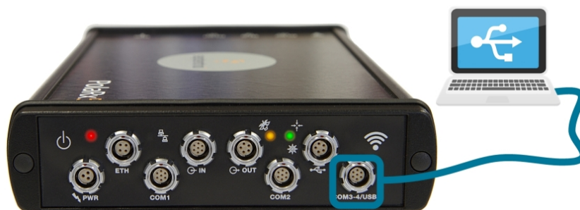
Abbildung 3-3: Verbindung mit dem USB-Stecker auf der Vorderseite
