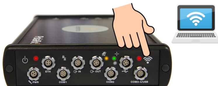
Abbildung 3-6: Drücken Sie fest auf die WLAN-Taste auf der Vorderseite, um das WLAN-Modem einzuschalten. Ist es aktiv, leuchtet die WLAN-LED.
