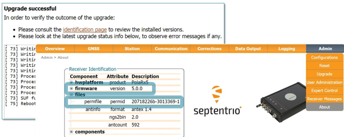
Abbildung 7-6: Überprüfung der Firmwareversion und Lizenzdateien
