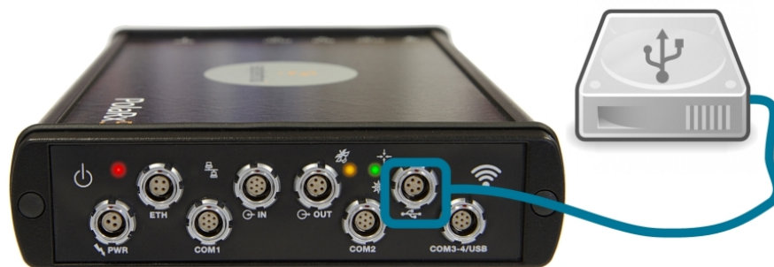
Abbildung 4-26: Verbindung eines externen USB-Speichers mit dem PolRx5
