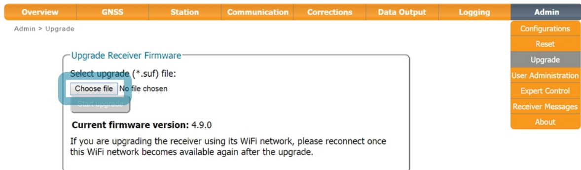
Abbildung 7-4: Auswahl der .suf-Datei für den Upload auf den Empfänger
