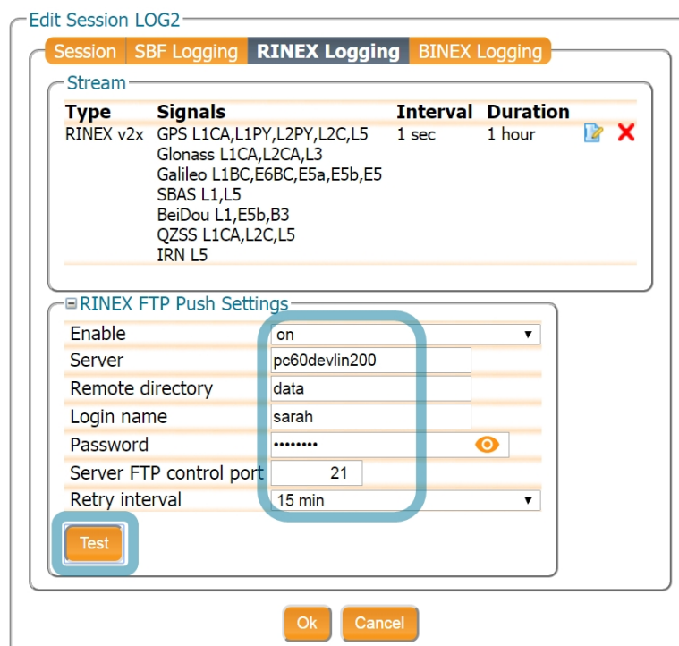
Abbildung 4-29: Konfiguration zum Pushen von RINEX-Dateien auf einen externen FTP-Server
