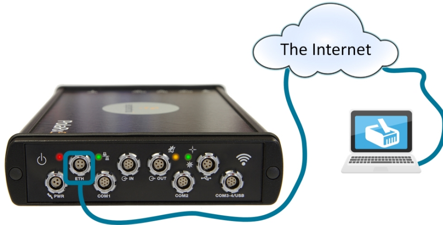
Abbildung 3-9: Verbindung mit dem Ethernet-Anschluss auf der Vorderseite
