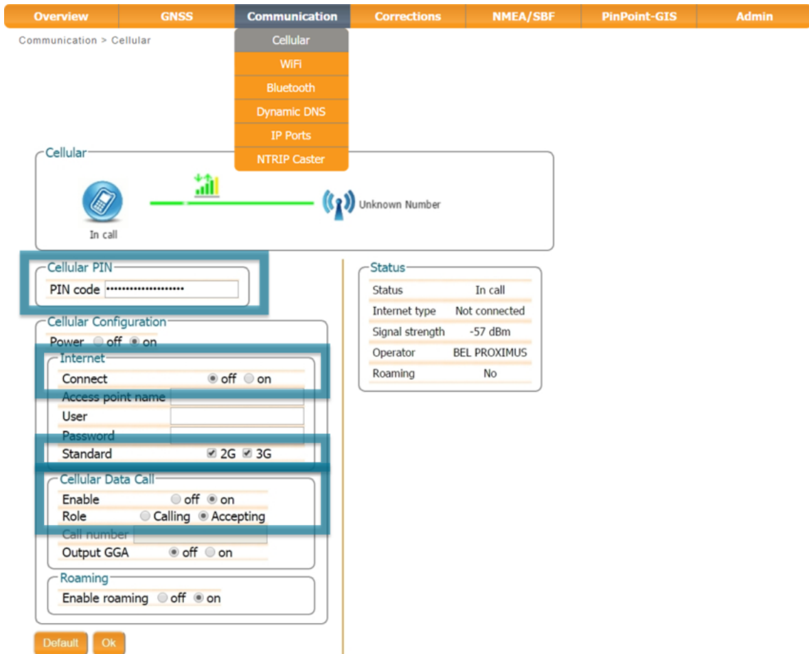
Abbildung 4-7: Konfiguration der Basisstation, um eine GSM-Verbindung (Datenanruf) vom Rover zu empfangen
