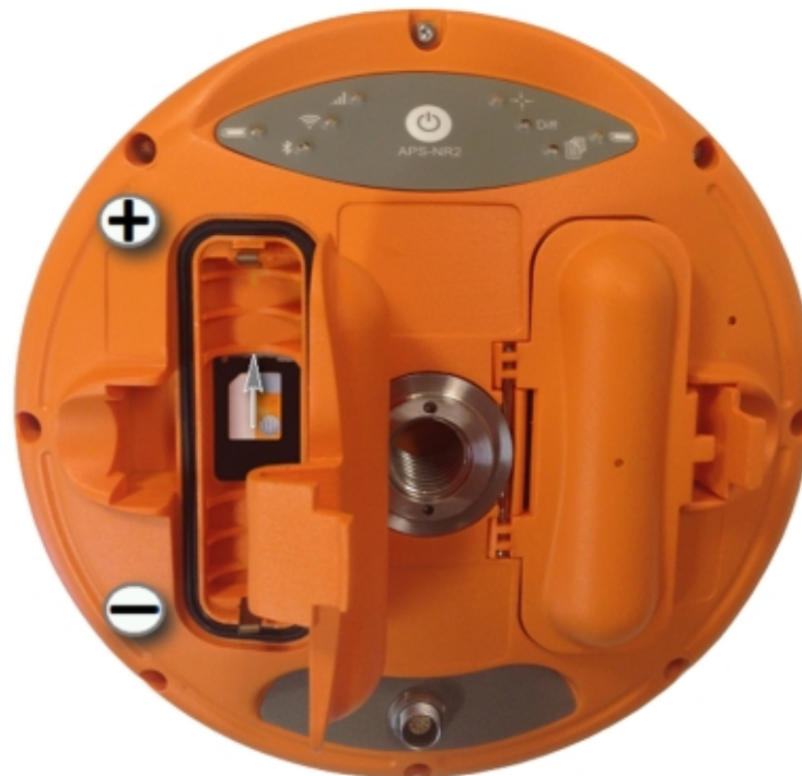
Abbildung 2-3: Die Unterseite des Altus NR3 zeigt das SIM-Karten-Fach an.
