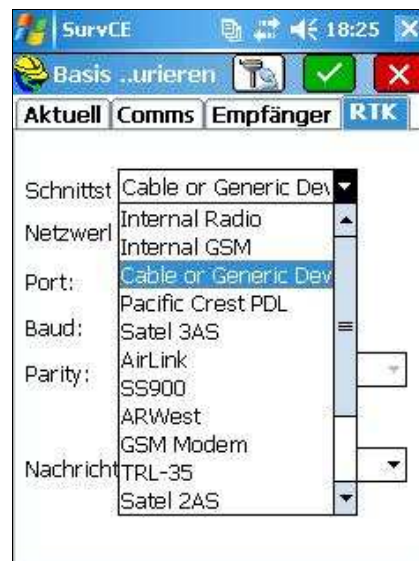
Abbildung 95: Basiskonfiguration über externes Kabel
