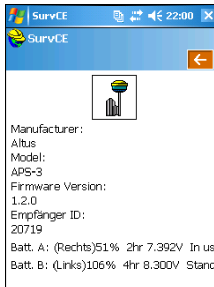
Abbildung 113: GNSS Firmware & Batterie Statusanzeige
