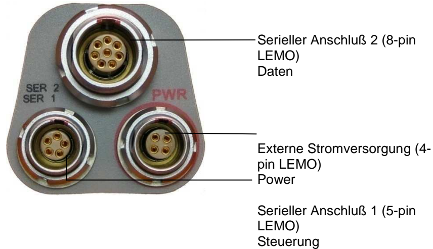
Abbildung 5: Beschreibung der Anschlüsse
