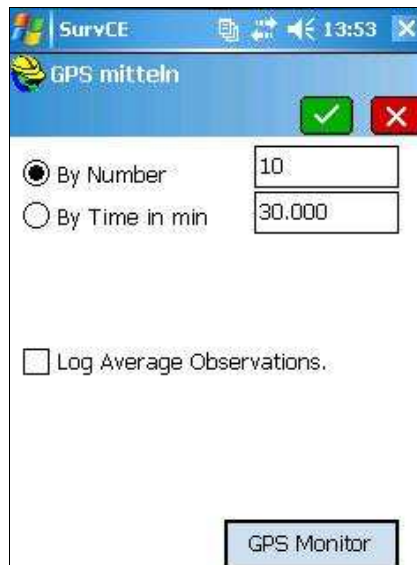
Abbildung 98: Ermittlung der Basis Koord. durch GPS
